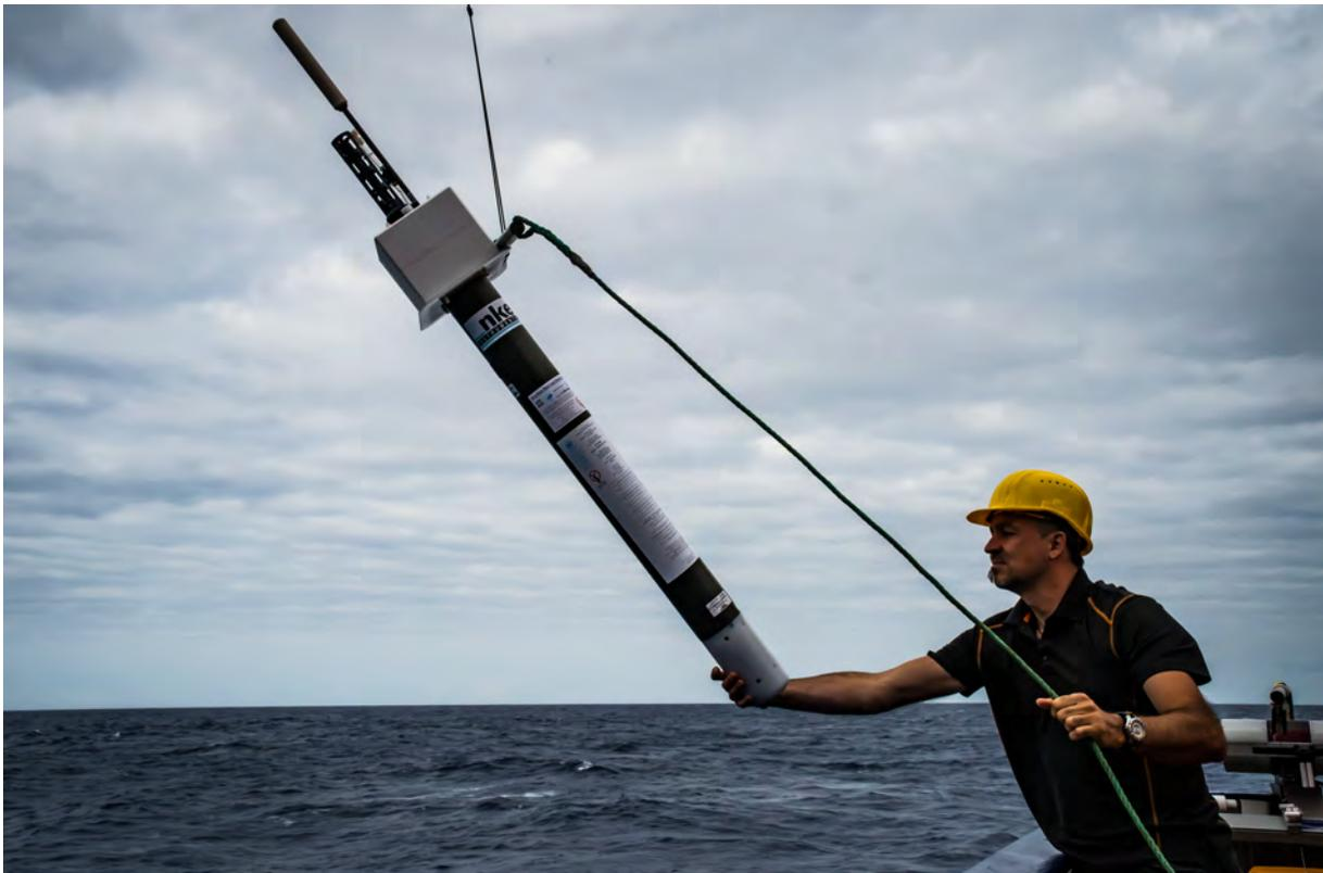
**Abb. 1:** Auslegen eines Argo Tiefendrifters (Foto: SvN).
