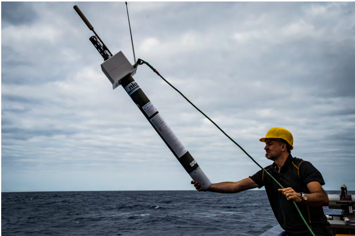
Abb. 1: Auslegen eines Argo Tiefendrifters (Foto: SvN).
