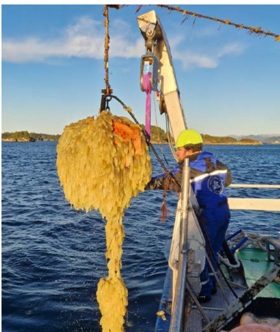
Det gror godt på Austevoll: Jean-Baptiste Danre rengjør målerigg etter få måneder i sjøen.
