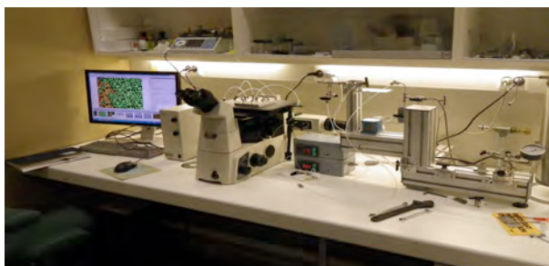
Mikrolab i Reservoarfysikk: Eksperimentelt oppsett og CO 2 flømming på porenivå i økt oljeutvinning.
