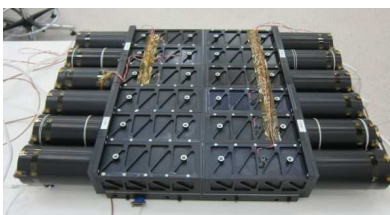
Bildet viser HED = High Energy Detector (4 x BGO DAU) under STM integrasjonen
