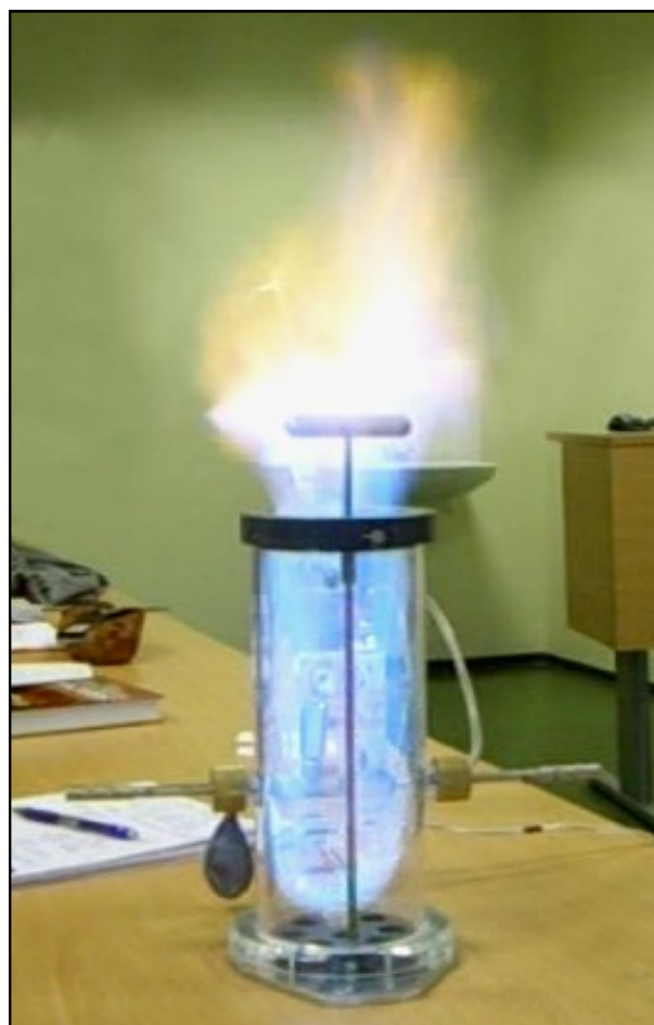
Foto av gaseksplasjon i en 2-liters pyrex-beholder. Demonstrasjon/øving i kurset PTEK250: "Eksplasjonsfarer i prosessindustrien". Innsendt av Rolf K. Eckhoff (prof.em.)
