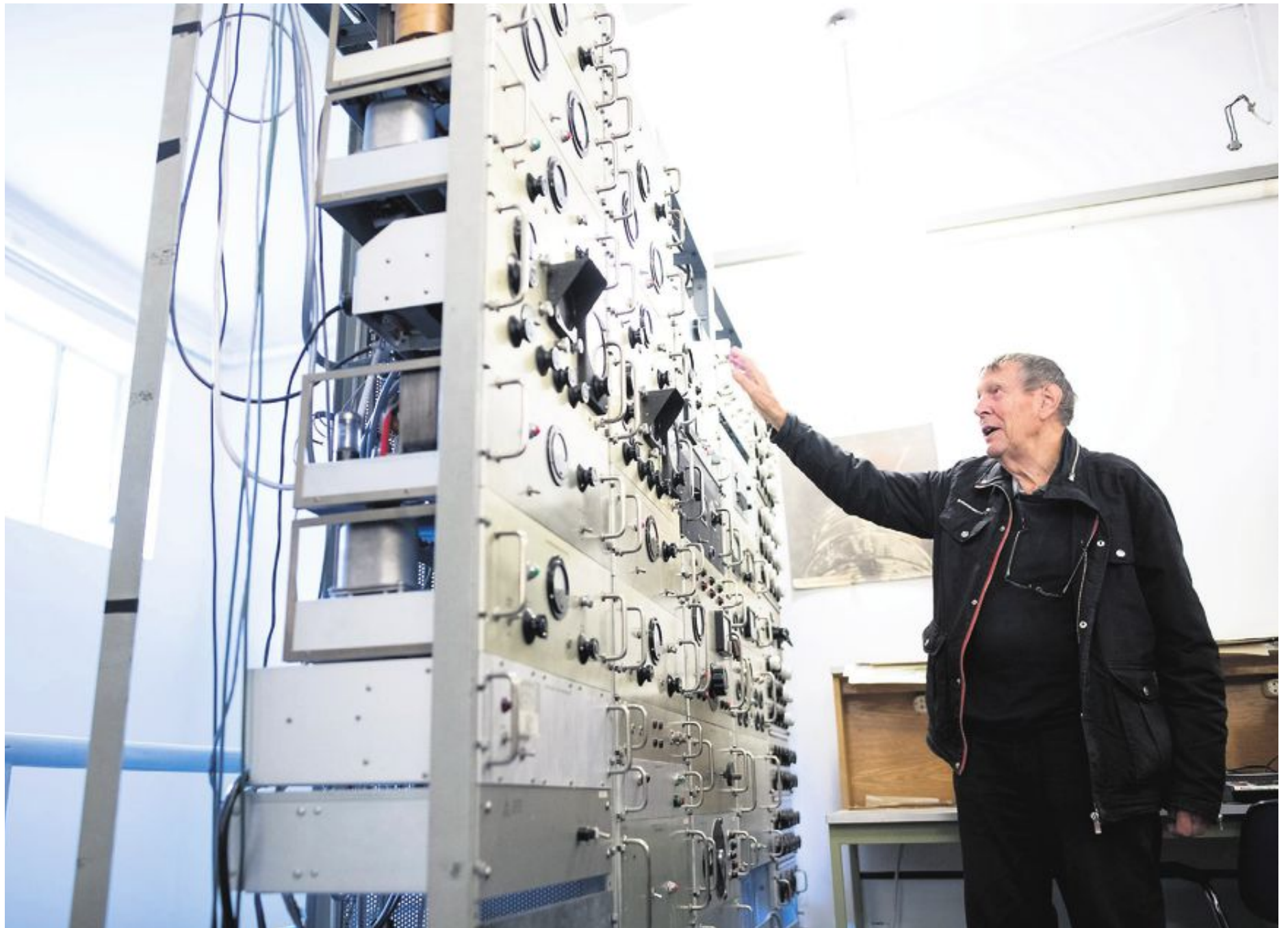
HJEMMELAGET: Instrumentpanelet som Arvid Erdal styrer Van de Graaff-generatoren fra.
