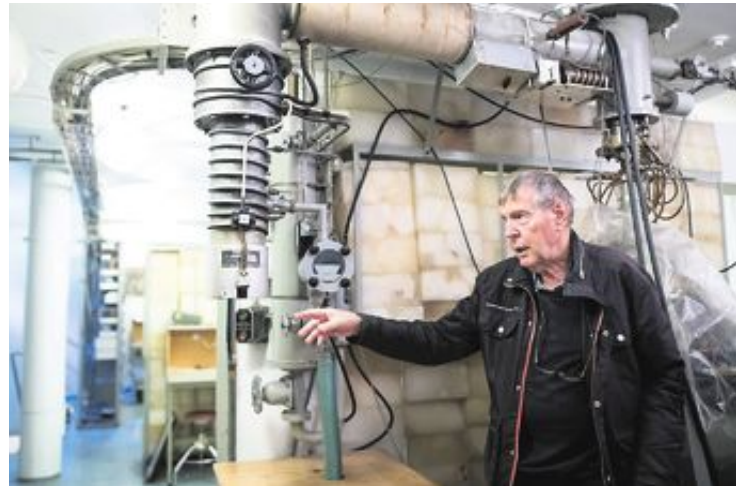
PARAFINVEGG: Bak Erdal ses de to veggene av parafin eller skivoks som er satt opp for å beskytte mot strålingen fra generatoren.
