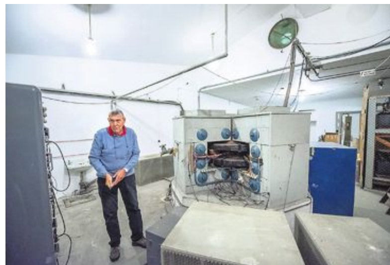
VETERAN: Dette er betatronen, en partikkelakselerator som lagde røntgenstråler. Den ble tatt i bruk rett etter krigen, og brukt til 1960-tallet. Bak vinduet på veggen er det fylt med vann, for å beskytte mot strålingen.
