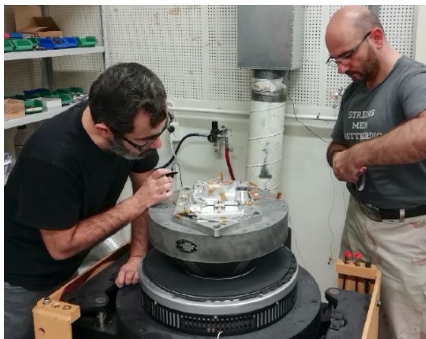
Topp: Kjøleboks for ASIC-testin (ATLAS) Nuno og Georgi klar for vibrasjonstest på Protech
