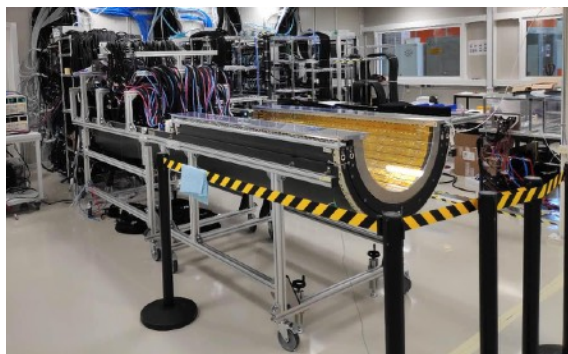
Halvparten av det indre sporrekonstruksjonssystemet i ALICE (bildet viser noen av lagrene). Detektoren er omtrent 150 cm lang og bredden er ca. 50 cm.
