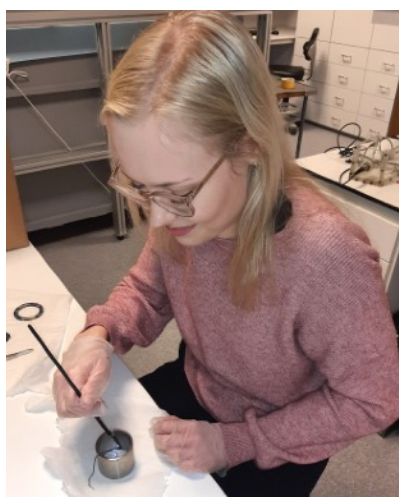
Celine sjekker liming i piezoelektrisk transduser
