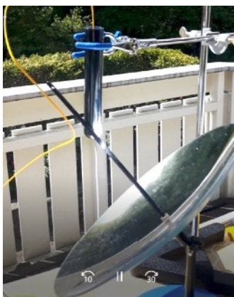
(v) Nanofluid utsatt for solståling i felteksperimenter; (n) Datasimulering av en solfanger
