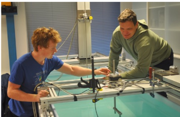
Robert og Audun med måleoppsett for studium av in situ måling av kalibreringsparametre for vitenskapelige ekkolodd i fiskeriakustikk.
